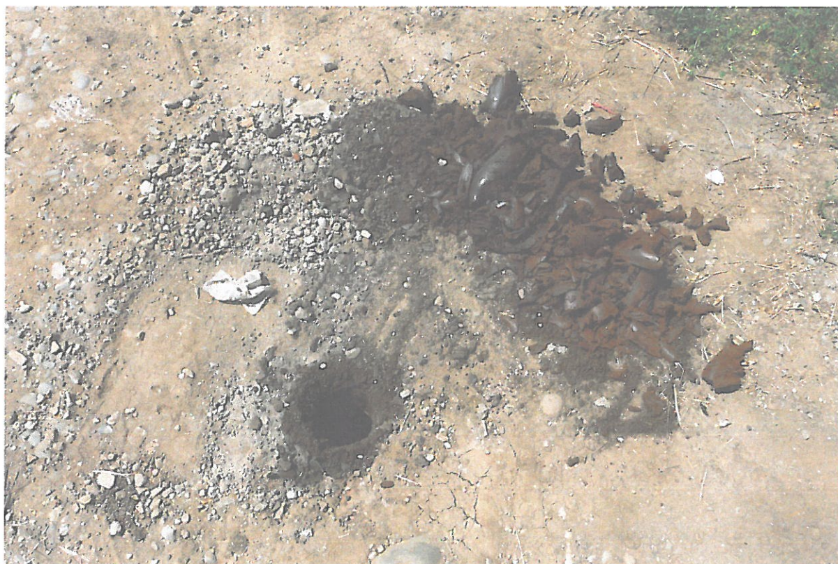
Foto 1 – succesiunea litologică interceptată în forajul geotehnic numărul 1
